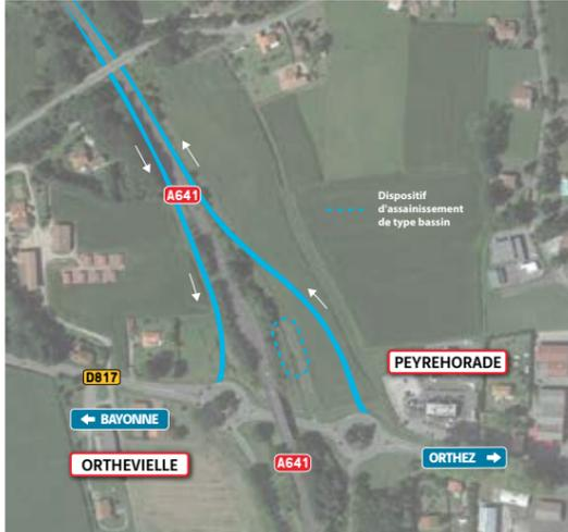
*Pour respecter les normes de conception géométrique et de sécurité, le raccordement des bretelles sur l'A641 devra être le plus perpendiculaire possible à la RD817 en entrée et se raccorder à l'A641 avec des rayons suffisamment grands pour assurer la visibilité et la sécurité des automobilistes qui l'emprunteront.*
